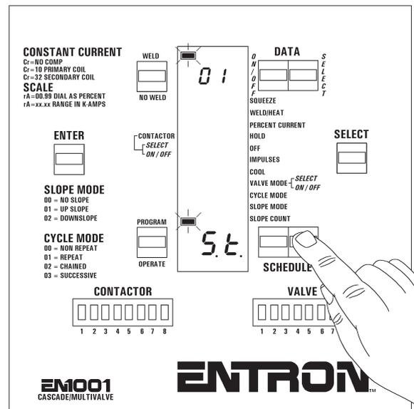
**Figure 7-1. STEPPER enabling**
